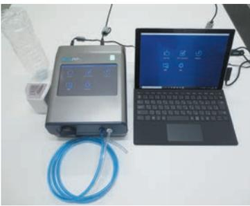
測定器本体(写真中央)にて粉じん量を測定します。透明チューブを防護マスクに接続し、外部粉じん量とマスク内部の粉じん量を測定し、マスクのフィットファクタを算出します。
